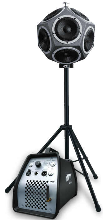
DS3 12面体スピーカーと PA3パワーアンプ
